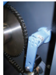
Kædestrammer i motorkasse
