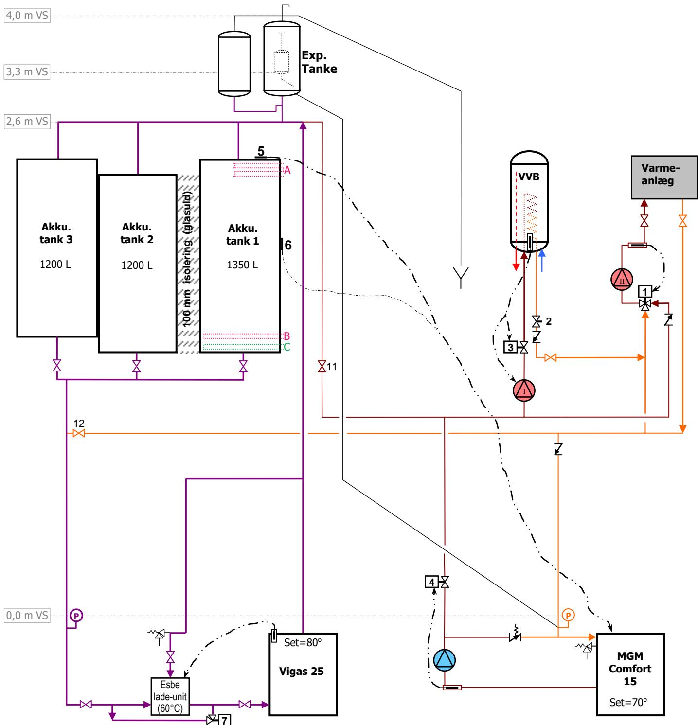
**1:** 3/4" Esbe 3-vejs termostatventil med Automix CT motorstyring. Setpunkt 40-60°C (årstidsafhængigt).
