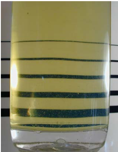
Diesel med frit vand på bunden
