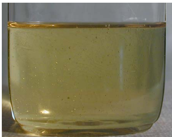
Hydraulikolie med vand på bunden
